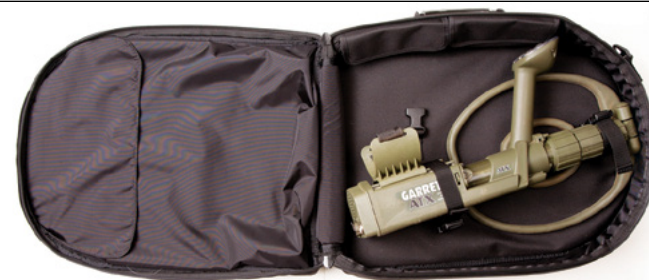
Figure 1 : ATX avec disque DD fixé. Fixer les sangles autour de l'écrou de la canne inférieure et du boîtier.
